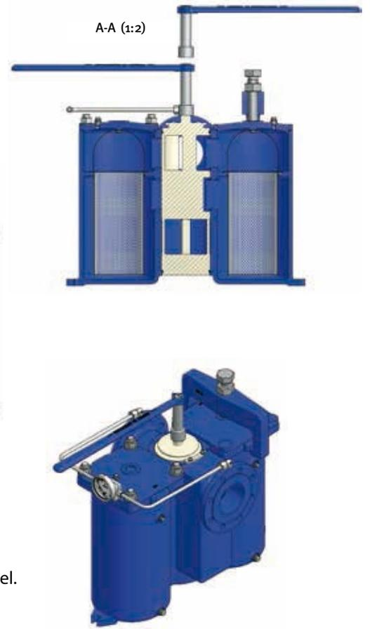
\*Die Schaltrichtung des Umschlaghebels ist durch Umsetzen des Anschlags variabel.
