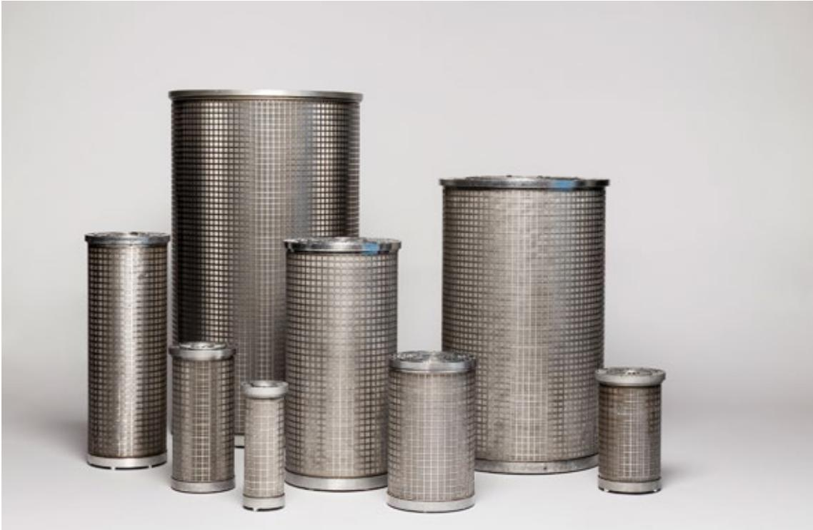
Der Mantelsiebeinsatz besteht aus mehreren zylindrischen Siebmänteln. Durch diese Konstruktion ergibt sich eine große Filterfläche bei geringem Raumbedarf und lässt die Verwendung feinsten Filtergewebe zu.
