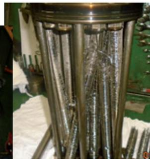
Billigprodukte halten den Anforderungen des Schiffsbetriebs nicht stand. Ein Versagen der Baugruppe erfolgt unter anderem durch Abwicklung der Metallfaser zu einem Knäuel. Diese abgelösten Metallreste können ungehindert an empfindliche Maschinenteile gelangen.
