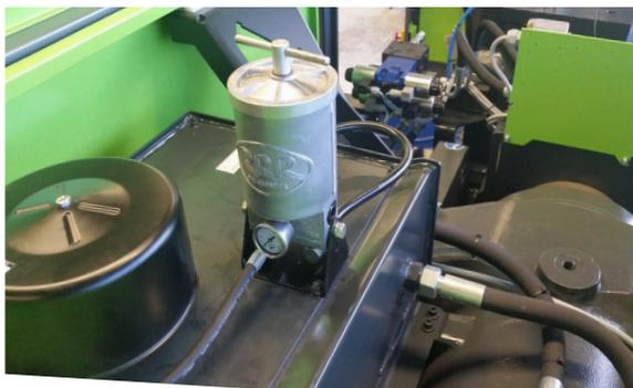
Triple R BU30 Bypass-Ölreiniger an der ENGEL-Maschine
