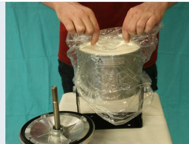
Schließen Sie die Kugelhane; Manometer Anzeige sollte "0" Bar sein. Drehen Sie mit die Hände diese T-Bolze offen und entfernen Sie die Deckel und U-Dichtung. Nehmen Sie das neue Filterelement aus dem Plastiktüte und platzten Sie diese Tüte über das Filter Gehäuse. Fassen Sie die Riemen an und entfernen Sie das verschmutzte Filterelement aus das Filter Gehäuse.
