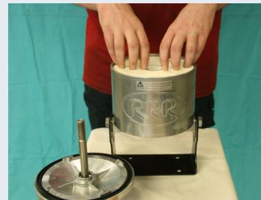
Wenn die Ecke von Filter Gehäuse sauber ist, drucken Sie das Neue Filterelement ins Filter Gehäuse. Pass auf! Filter Riemen nach oben, enge Seite nach unten! Drucken Sie jetzt das Filterelement gut an.
