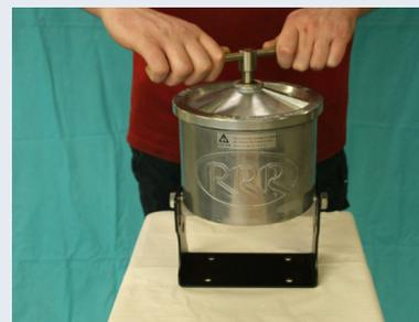
Platzen Sie diese U-Dichtung (wie in das Bild hier oben) und platzten Sie die Deckel. Jetzt nehmen Sie die T-Bolze mit Metall / Gummie Dichtung und schliessen Sie das Gehäuse. durch diese T-Bolze NUR mit die Hände und leicht an zu drehen.
