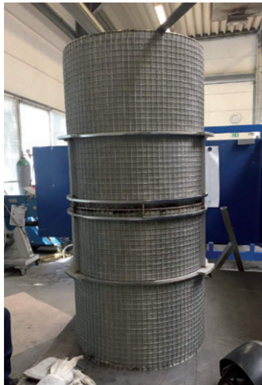
Bild 3: Komplett neu erstellter Seewasserfiltereinsatz mit Materialien aus dem Hause FIL-TEC RIXEN GmbH®
